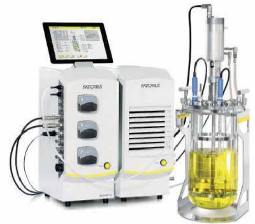
**Sartorius.** BIostat®A utilizado para el cultivo de células en suspensión BHK-21 y medio CD 4Cell® BHK-21.
